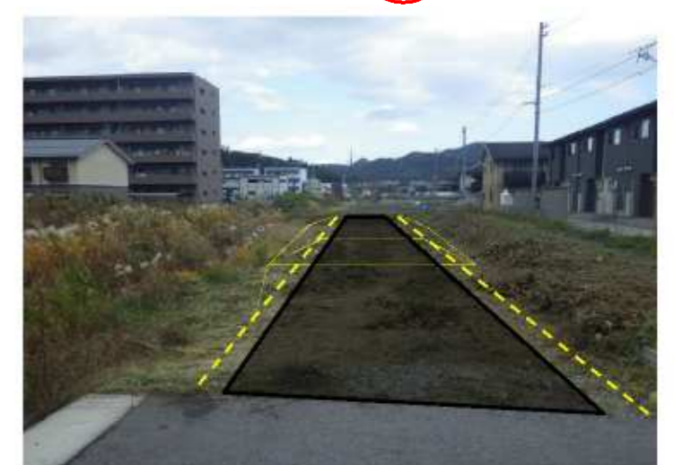
※家屋が近接する箇所は、仮舗装を行います。
